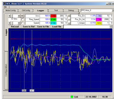
Abb 56: Erste Version der PID-Parameter
