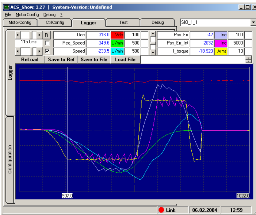
Abb 84: Falscher Resolver Offset, Speed Waves
