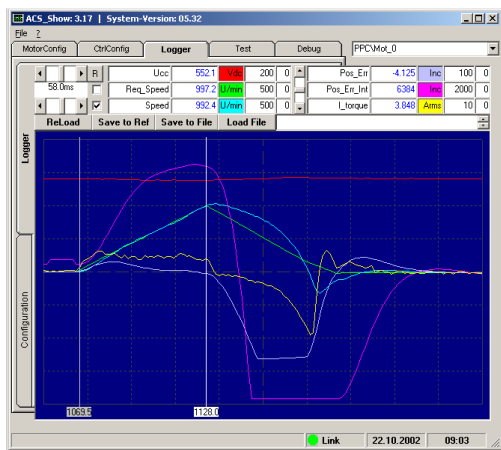
Abb 79: Falsches Ke; Aufzeichnung mit Speed Waves
