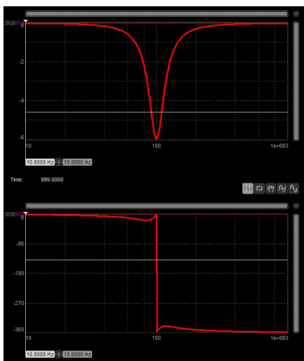
Abb 65: Notch-Filter -6dB Dämpfung
