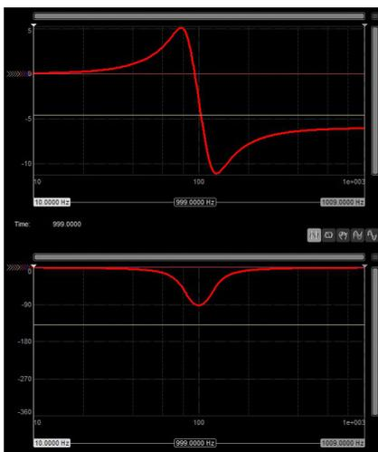
Fig. 67: Two-Load Filter Güte=3
