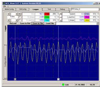
Fig. 54: Critical amplification  $kP_{crit}$
