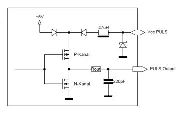
bride auf die Montageplatte aufgelegt werden. Es ist auf eine gute Verbindung zwischen den GND-Anschlüssen des Moduls und dem Ground der 24V, bzw. der Vcc PULS Speisung zu achten.
