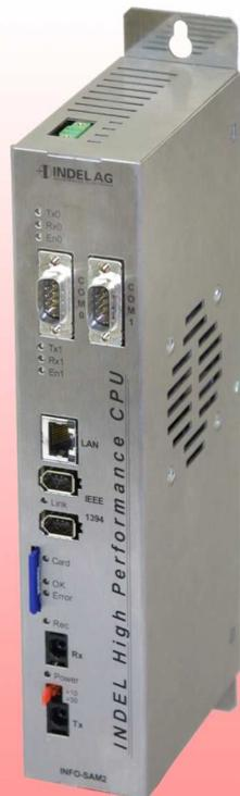
Die INFO-StandAloneMaster Karte ist der Feldbusmaster über einen INFO-Link. Die Karte läuft völlig autonom, und braucht im Betrieb keinen übergeordneten Rechner. Für die Visualisierung und Software Updates stehen ein 100MBit Ethernet Port und zwei RS232 Schnittstellen und zur Verfügung. Das echtzeitfähige Multitasking-Betriebssystem des Masters übernimmt die gesamte Steuerung der Maschine/
