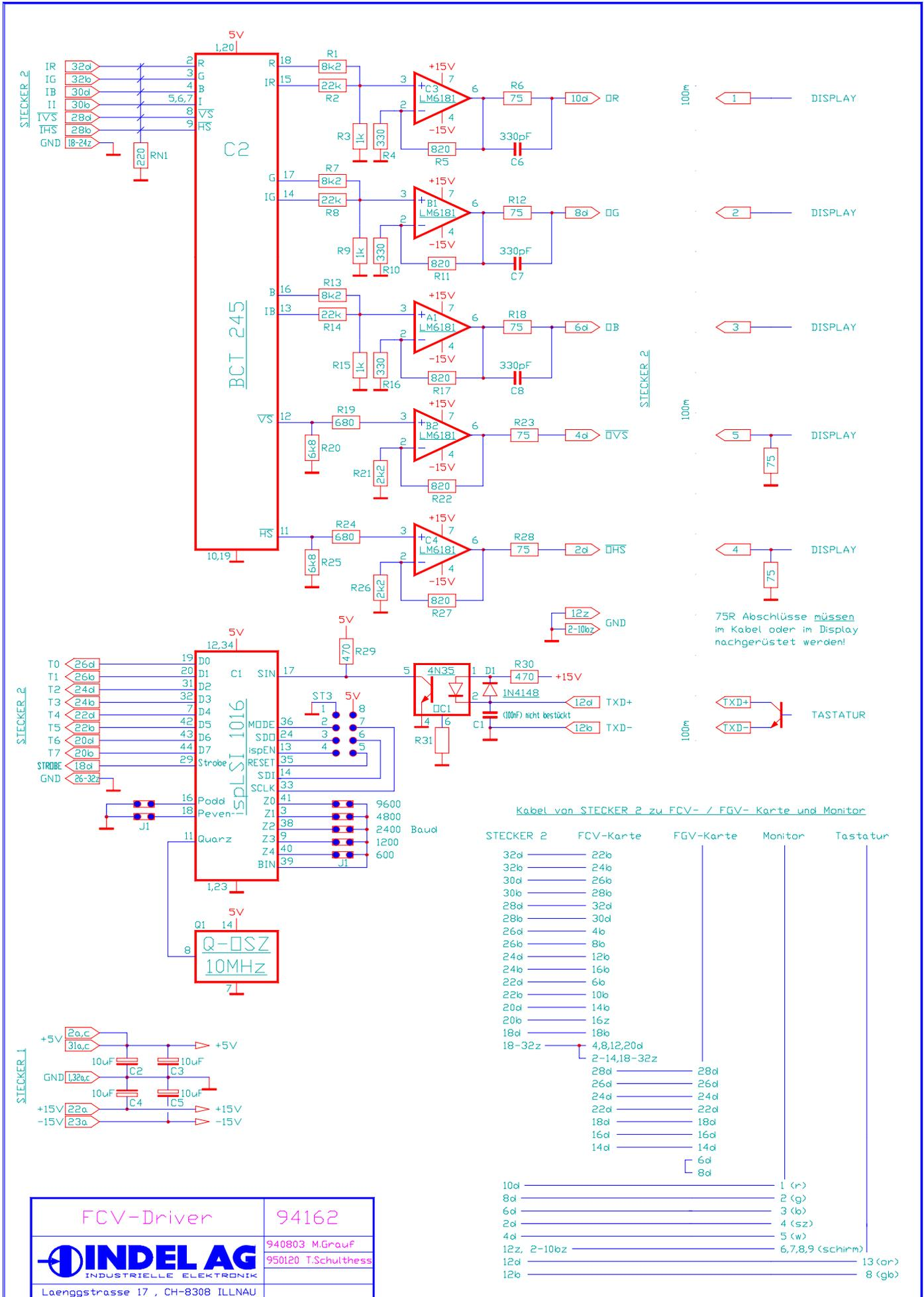
75R Abschlüsse müssen im Kabel oder im Display nachgerüstet werden!
